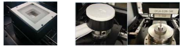
図11 試験セットアップ追加モジュール各種（環境チャンバー・温度、湿度）。回転運動モジュール
