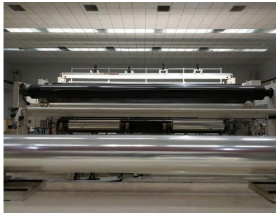
図 6. 稼働中の検査システム
