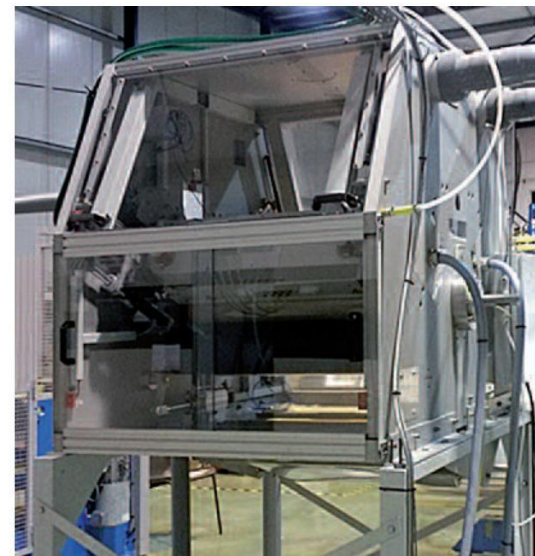
お客様の工場に設置する前のプラズマステーションのクオリフィケーションテスト
